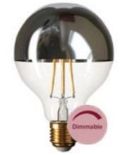
DL700176 H 140mm, L 95mm 7W - 2700K - 806 Lm
